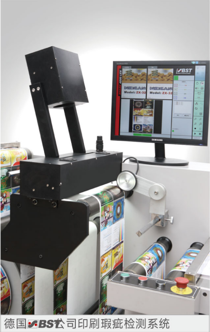
德国BST公司印刷瑕疵检测系统 BST (Germany) Inspecting System
